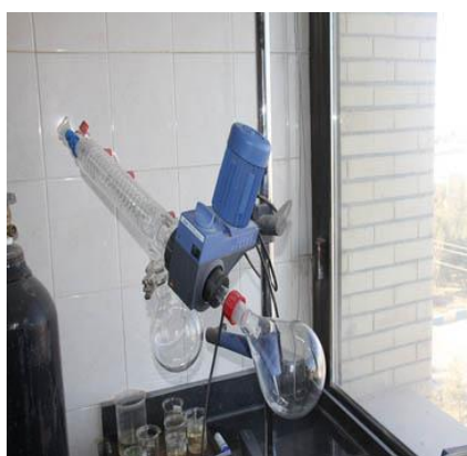
روتاری برای تغلیظ، خالص سازی و جداسازی محلول های شیمیایی با قابلیت اتصال به پمپ خلاء
