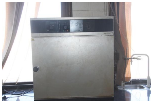
آون برای خشک کردن شیشه آلات و ترکیبات آزمایشگاهی با قابلیت تنظیم دما
