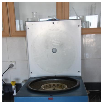
دستگاه سانتریفوژ برای جداسازی جامدات از یک مخلوط کلوئیدی توسط نیروی گریز از مرکز
