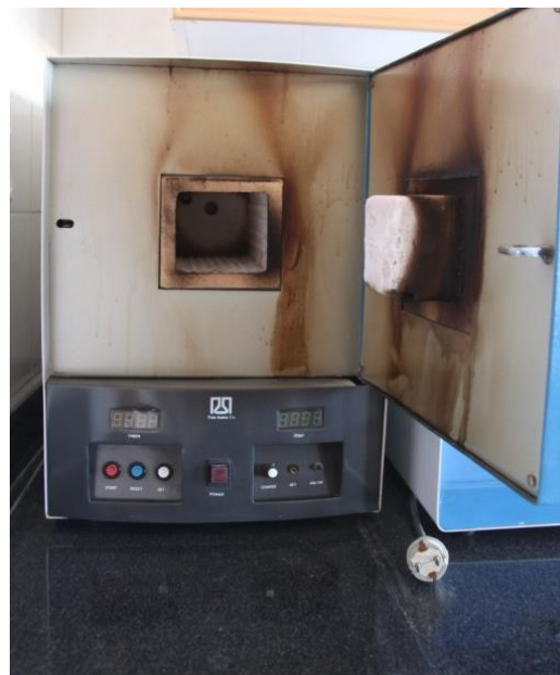
کوره الکتریکی برای دستیابی به دماهای بالا در حدود ۱۲۰۰ درجه سانتیگراد
