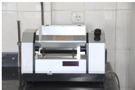
اندازه گیری جهت و میزان چرخش نور قطبیده مسطح ترکیبات فعال نوری
