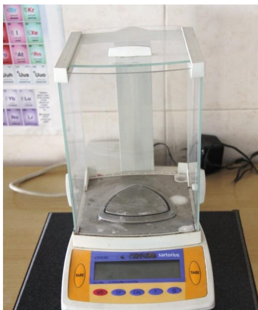
ترازوی تجزیه ای برای اندازه گیری جرم ترکیبات تا ۰/۱ میلی گرم
