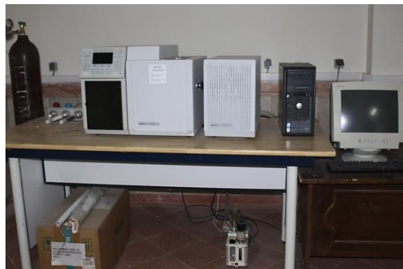
دستگاه GC-MS کروماتوگرافی گازی با قابلیت جداسازی مواد فرار و شناسایی آنها از طریق طیف جرمی
